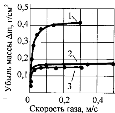
Рис.1.4. Влияние скорости движения газовой среды на кинетику коррозии стали с 0,15%С при температуре 1260°С (выдержка 40 мин): 1 - пары воды, 2-воздух, 3-углекислый газ.
